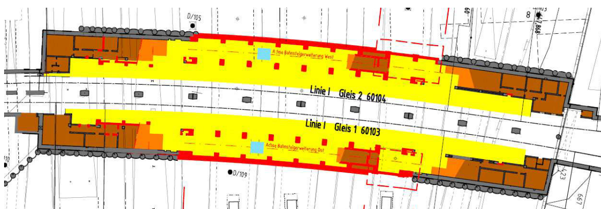
Abb. 30 Stadtbahnanlage Dortmund Hbf: Maßnahme Bahnsteigverbreiterung
