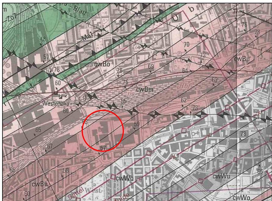
**Bild 27:** Karbonoberfläche - Schichteinfallen 67 gon
