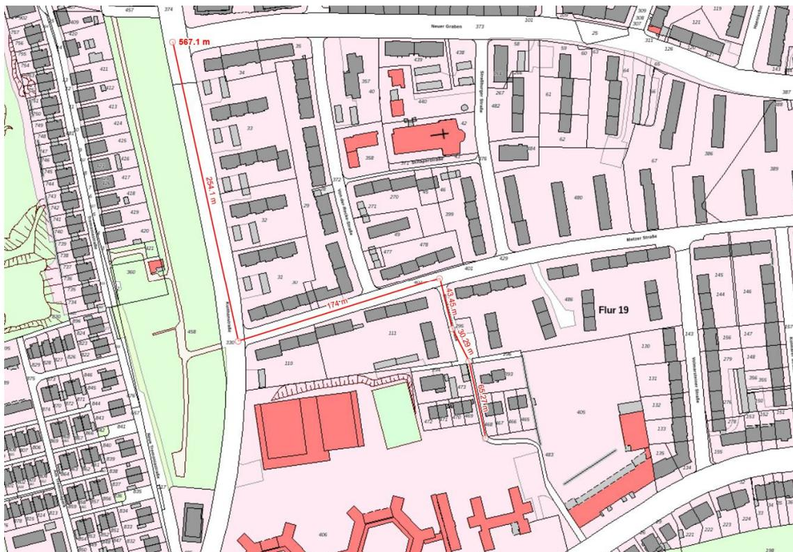
Abb. 7: Denkbare Kanalsanierungsstrecke bis zum Hauptsammler ZAP Neuer Graben, der Weg über die Kuithanstraße kann gleich die Vorflut für Leibnitz-Gymnasium und Röntgen-Realschule verbessern
